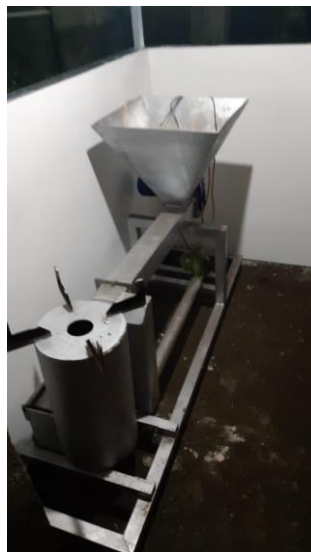
Gambar 3. Biomass automatic hybrid stove burners berbahan bakar LPG Sumber: TIM Praktik Pengembangan Masyarakat Prodi Pengembangan Masyarakat Islam UIN Sunan Kalijaga
